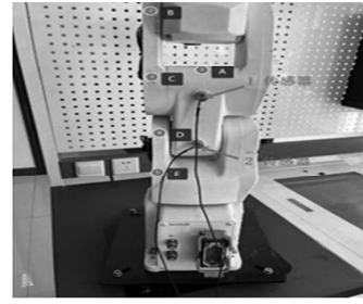
(b) 传感器布置和铅芯折断点图
