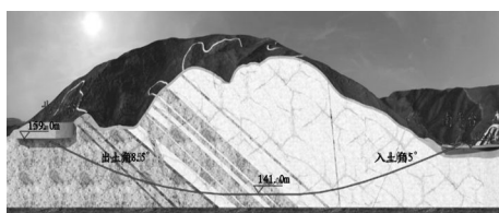
图 2 管道回拖现场施工示意图
